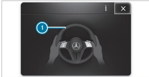
Si le système détecte que le conducteur ne dirige pas lui-même le véhicule ou qu'il lâche le volant pendant une période prolongée, l'affichage ❶ apparaît. Si le conducteur ne dirige toujours pas activement le véhicule ou ne donne pas de signal
