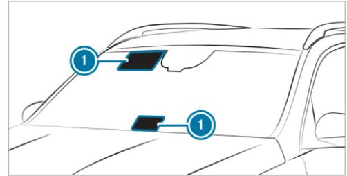
Montez les appareils commandés par radio, tels que les systèmes de télépéage, uniquement dans les zones du pare-brise laissant passer les ondes radio ①.
