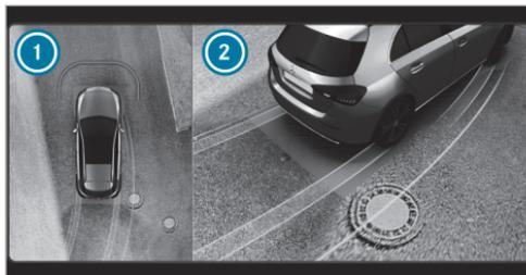
Dans la vue 3D, côté gauche/droit du véhicule, la caméra virtuelle se déplace du côté correspondant du véhicule ②. Lorsque vous changez la position de la boîte de vitesses, la perspective s'adapte automatiquement. En outre, la vue du dessus ① est affichée avec l'affichage d'alerte de l'assistant de stationnement PARKTRONIC.
