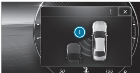
Lorsqu'une intervention de freinage permettant de corriger la trajectoire a lieu, le voyant rouge d'alerte intégré au rétroviseur extérieur clignote et un signal d'alerte retentit. En outre, un affichage ⓘ signalant un risque de collision latérale apparaît sur l'écran conducteur.
