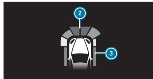
Les obstacles détectés par l'assistant de stationnement PARKTRONIC se trouvant à moins de 3,3 ft (1,0 m) environ à l'avant ② et 2,3 ft (0,7 m) environ sur les côtés ③ apparaissent, en option, également dans l'affichage tête haute.
