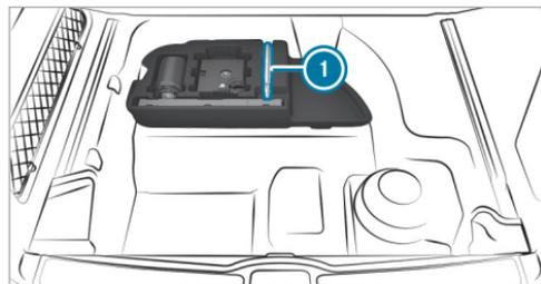
L'anneau de remorquage ① se trouve avec l'outil de changement de roue sous le plancher du compartiment de chargement.
