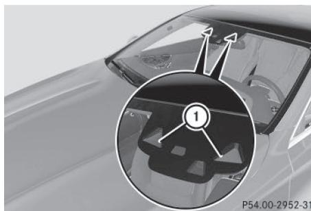
L'assistant de trajectoire actif surveille la zone située devant votre véhicule à l'aide d'une caméra multifonction ① fixée en haut du pare-brise. En outre, différentes zones situées à l'avant, à l'arrière et sur les côtés de votre véhi-
