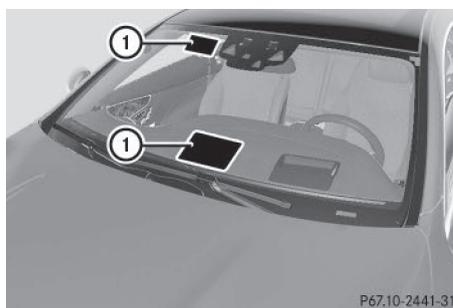
Ce vitrage spécial évite qu'il ne fasse trop chaud à l'intérieur de l'habitacle. En outre, il arrête les ondes radio dont les fréquences peuvent être de l'ordre du gigahertz.
