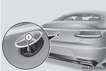
La caméra de recul ① se trouve sous un volet sur le couvercle du coffre.
