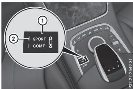
En mode « Sport », le réglage plus ferme de la suspension permet un contact optimal avec la chaussée. Sélectionnez ce mode pour une conduite énergique, par exemple sur des routes de campagne sinueuses.
