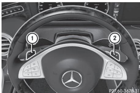
Dans les programmes de conduite automatiques **E** (**C** dans le cas des véhicules Mercedes-AMG) et **S**, vous pouvez activer le programme de conduite manuel **M** à l'aide des palettes de changement de rapport au volant ① et ② (▷ page 148). Dans le programme de conduite manuel **M**, vous pouvez changer vous-même brièvement de rapport en utilisant les palettes de changement de rapport au volant.
