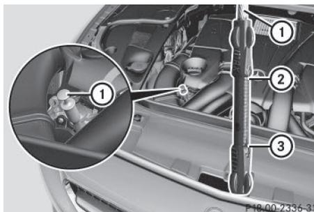
Contrôle du niveau d'huile avec une jauge à huile (exemple)
