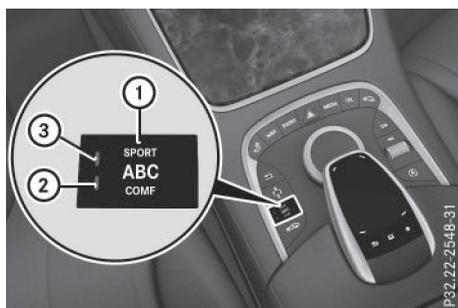
En mode de conduite CURVE, le véhicule s'incline de manière active dans les virages. Cette fonction d'inclinaison associée au programme d'amortissement « Confort » augmente le confort de marche dans les virages. La fonction CURVE est disponible entre 18 et 100 mph (30 et 160 km/h). Sélectionnez ce mode surtout sur des routes sinueuses. En dehors de cette plage de vitesse, le mode de conduite CURVE équivaut au mode Confort.
