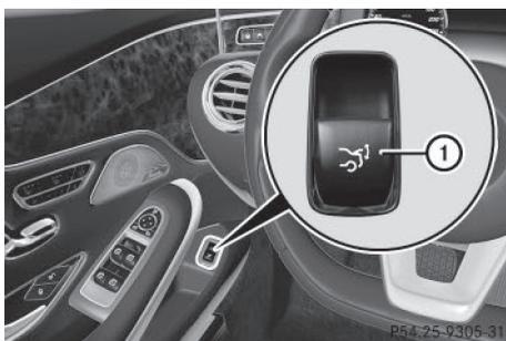
► **Ouverture:** tirez la touche de commande à distance du coffre ① jusqu'à ce que le coffre s'ouvre.
