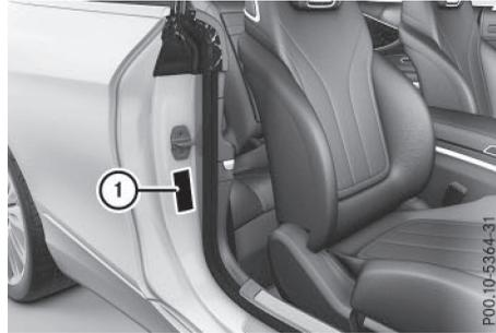
Emplacement de la plaque constructeur du véhicule (exemple : véhicule avec direction à droite)
