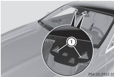
Le DISTRONIC PLUS avec direction active et Stop&Go Pilot vous aide à conduire au milieu de la voie par de légers braquages dans une plage de vitesse entre 0 et 125 mph (0 et 200 km/h). Il surveille la zone située devant votre véhicule à l'aide d'une caméra multifonction ① fixée en haut du pare-brise.
