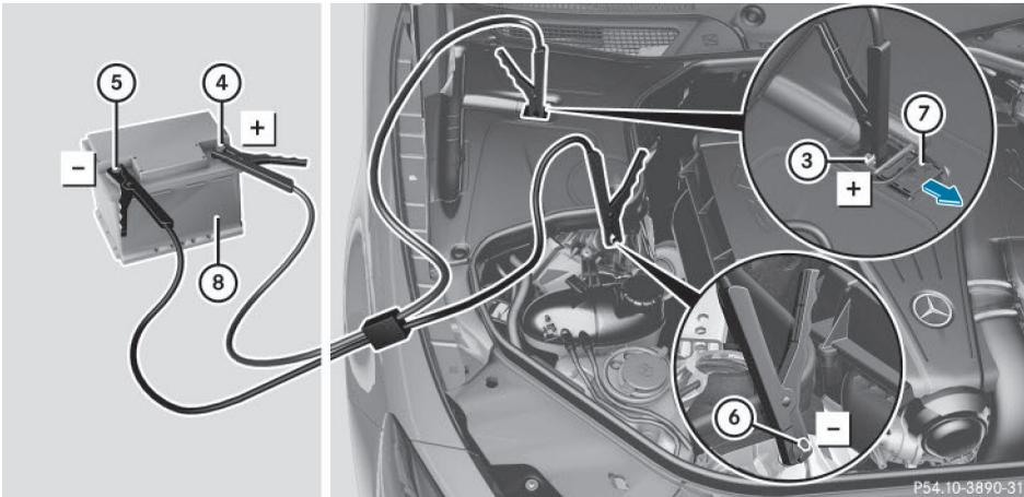
Le numéro ⑧ indique la batterie chargée de l'autre véhicule ou un dispositif d'aide au démarrage.
