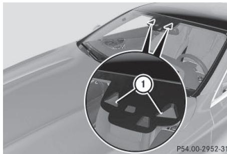
La fonction ROAD SURFACE SCAN surveille la route à l'avant du véhicule à l'aide d'une caméra multifonction ① fixée en haut du pare-brise. Cette fonction est activée automatiquement lorsque vous sélectionnez le programme d'amortissement « Confort ». Ce système fonctionne jusqu'à une vitesse de 81 mph (130 km/h).
