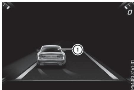
Lorsqu'une intervention de freinage permettant de revenir sur la voie empruntée a lieu, un affichage ① apparaît sur le visuel multifonction. L'intervention de freinage réduit également légèrement la vitesse du véhicule.
