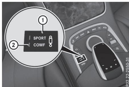
En mode « Confort », la conduite de votre véhicule est plus confortable. Sélectionnez par conséquent ce mode si vous préférez une conduite confortable. Sélectionnez aussi le mode de conduite Confort pour les lignes droites rapides, par exemple sur autoroute.
