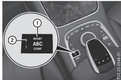
En mode de conduite SPORT, le réglage plus ferme de la suspension permet un contact avec la chaussée encore meilleur. La réactivité de la direction est plus spontanée. Sélectionnez ce mode sur des routes de campagne ou des autoroutes sinueuses, par exemple.
