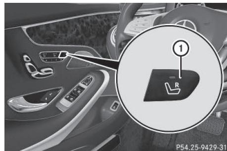
Pour que le siège du passager puisse être sélectionné, l'alimentation électrique doit être établie ou le contact mis (▷ page 136).
