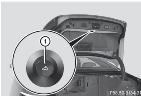
La touche de déverrouillage de secours ① vous permet de déverrouiller le coffre de l'intérieur.
