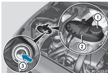
Contrôle du niveau du liquide de refroidissement (exemple)
