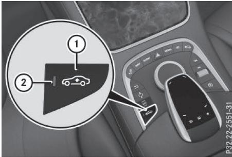
Pendant la marche, le niveau surélevé peut uniquement être réglé lorsque la vitesse est inférieure à 75 mph (120 km/h).
