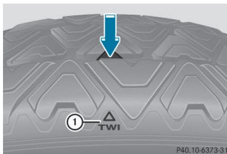
Le repère ① indique l'emplacement auquel l'indicateur (flèche) d'usure de la bande de roulement, qui se présente sous la forme d'une barrette, est intégré dans les sculptures du pneu. Les indicateurs d'usure de la bande de roulement sont prescrits par la loi. Les indicateurs sont répartis en 6 points sur la bande de roulement. Ils sont visibles dès que la profondeur des sculptures atteint environ  $\frac{1}{16}$  in (1,6 mm). Dans ce cas, l'usure du pneu est telle qu'il doit être remplacé.
