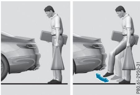
► **Ouverture ou fermeture:** balancez le pied dans la zone de détection des capteurs ① sous le pare-chocs. Un signal d'alerte retentit lorsque le coffre s'ouvre ou se ferme.
