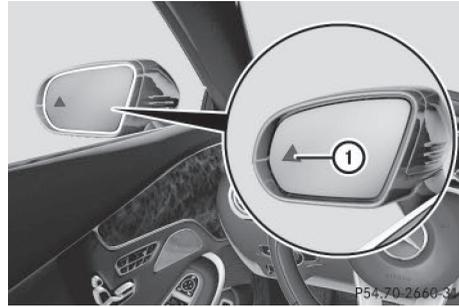
L'avertisseur actif d'angle mort n'est pas opérationnel en dessous de 20 mph (30 km/h) environ. Dans ce cas, les véhicules qui se trouvent dans la zone de surveillance ne sont pas affichés.
