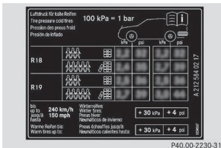
Certains tableaux des pressions de gonflage des pneus mentionnent uniquement le diamètre des jantes (**R18**, par exemple) à la place des dimensions de pneus complètes. Le diamètre des jantes est indiqué dans les dimensions des pneus et figure sur le flanc des pneus (▷ page 350).
