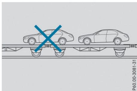
❗ Lorsque le véhicule est chargé en vue de son transport, ses essieux avant et arrière doivent être immobilisés sur un seul et même véhicule destiné au transport. Un positionnement sur un accouplement du véhicule destiné au
