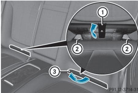
Les étriers de fixation ISOFIX (2) des sièges arrière sont recouverts d'une protection rembourrée relevable (3) avec bande velcro.
