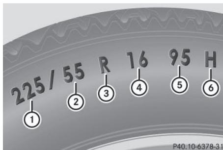
**Généralité:** en fonction des standards définis par le fabricant, les dimensions du pneu inscrites sur le flanc peuvent être ou non précédées d'une lettre.
