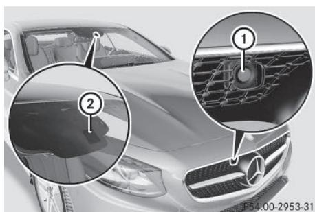
Le système de vision de nuit Plus complète l'éclairage des projecteurs normaux par une lumière infrarouge. La caméra ② du système de vision de nuit Plus, sensible à la lumière infrarouge, fournit une image en niveaux de gris sur
