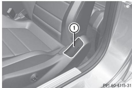
Les airbags bassin ① se déploient au niveau de la partie inférieure des joues extérieures des sièges. Ils se déclenchent
