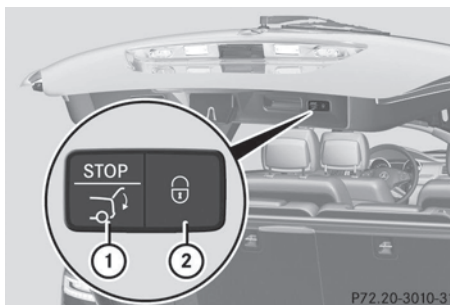
Touche de fermeture et touche de verrouillage (exemple: véhicule équipé d'un hayon EASY-PACK et de la fonction KEYLESS-GO)
